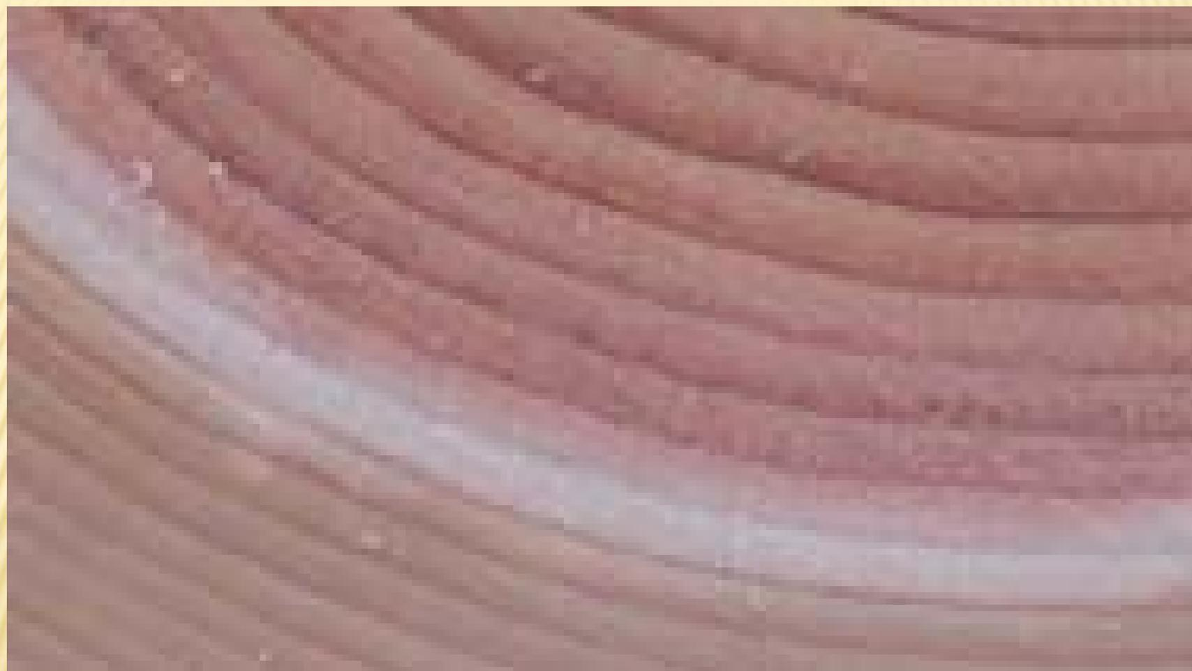
**移行帯の幅は1年輪ほどで、2年輪を超えない。写真は2月21日に岡山県津山市の製材工場で撮影**
